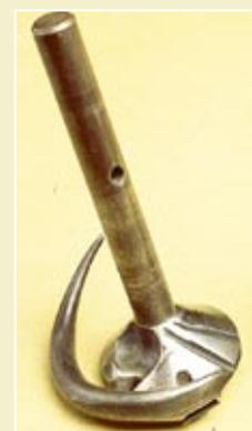
Auch die konischen Garnhalter der Cormick-Knoter müssen bei deutlichen Einlaufspuren ausgetauscht werden. Neue Garnhalter haben außerdem zur besseren Selbstreinigung einen Schlitz im Schaft, der über eine Bohrung von unten zugänglich ist.
