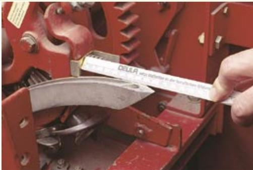
Lösen Sie zunächst den Bindevorgang aus, und drehen Sie dann das Schwungrad von Hand, bis die Nadeln die oberste Stellung erreicht haben. Jetzt können Sie den Abstand zwischen der Blattfeder und der Nadelspitze messen.
