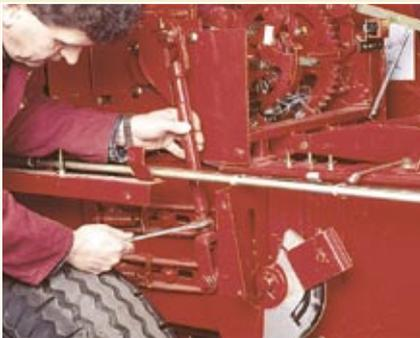
Je nach Knoter müssen die Nadeln entweder etwas Abstand zum Knoterrahmen haben oder leicht schleifen. Den Abstand messen Sie am besten mit einer Fühlerlehre, den Anlagedruck mit einer Federzugwaage. Zum Einstellen verschieben Sie die Nadeln auf der Schwinge oder richten sie mit der Hand.
