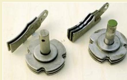
Falls Ihre Presse mit Deering-Knoter noch Garnhalter mit nur zwei Vorspannplatten hat (links), sollten Sie diese ersetzen. Die neuen Garnhalter mit drei Vorspannplatten halten das Garn zuverlässiger. Aber auch Dreifach-Garnhalter mit deutlichen Verschleißspuren (rechts) müssen unbedingt erneuert werden.
