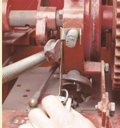
Stimmt der Abstand nicht mit dem in der Betriebsanleitung angegebenen Maß überein, müssen Sie die Kontermutter der Nadelzugstange lösen, den unteren Bolzen ausbauen und die Zugstange entsprechend länger oder kürzer drehen.
