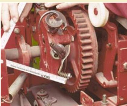
Um die Federspannung des Knoterschnabels zu kontrollieren, lösen Sie die Befestigungsschraube und schwenken die gesamte Knotereinheit hoch. In der Regel geben die Hersteller für die Federspannung bestimmte Federmaße vor.
